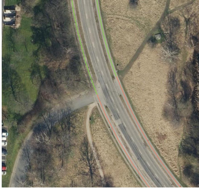
Figur 9. Illustration af fejlregistrering, idet vej kategorien skifter fra Cykelsti langs vej (rød) til Cykelbane langs vej (grøn), selvom forholdene ikke skifter i marken.
