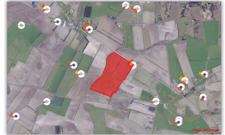
Figur 5.2: Cyklogrammer over nærliggende borer fra JUPITER databasen.
