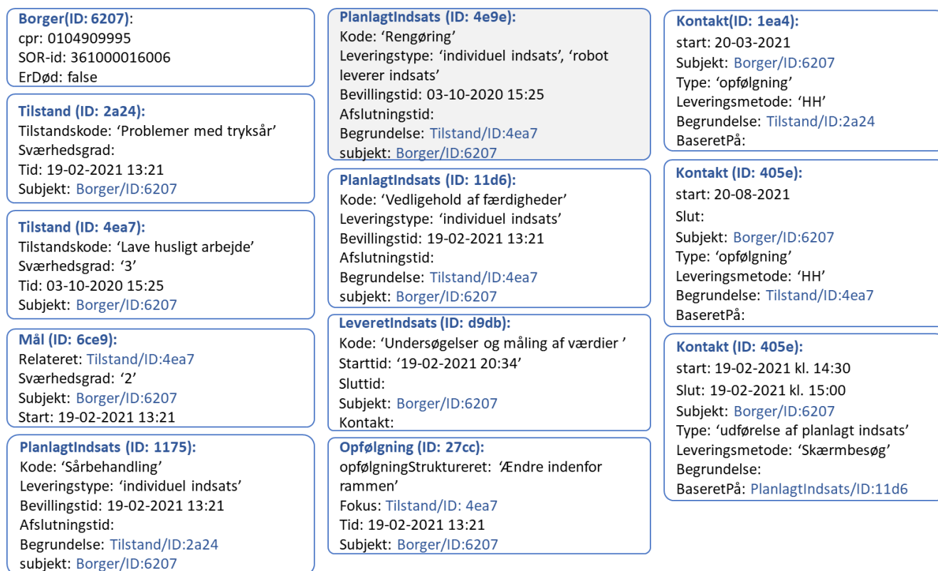
Figur 11 – Samlet illustration af Sverre eksemplets FKGateway-rapport. Her bliver det tydeligt, hvordan modellerne refererer til hinanden vha. ID'er. Læg mærke til at modellen PlanlagtIndsats vedr. rengøring er grå. Det er fordi den ikke indberettes, for den har nemlig ikke i forhold til eksemplets ordlyd ændret sig, siden seneste FKGateway-rapport. For nærmere forklaring henvises til bilag 2.
